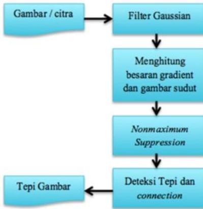
Gambar 2 : Langkah-langkah Algoritma Canny
