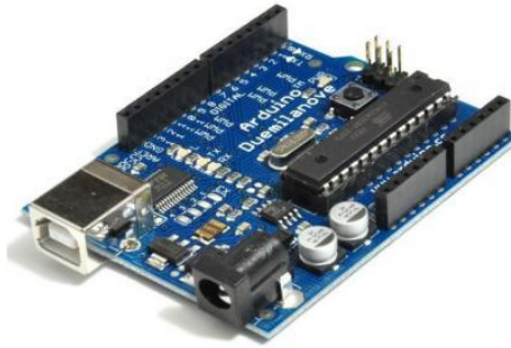
Gambar 2. Contoh mikrokontroler Arduino
